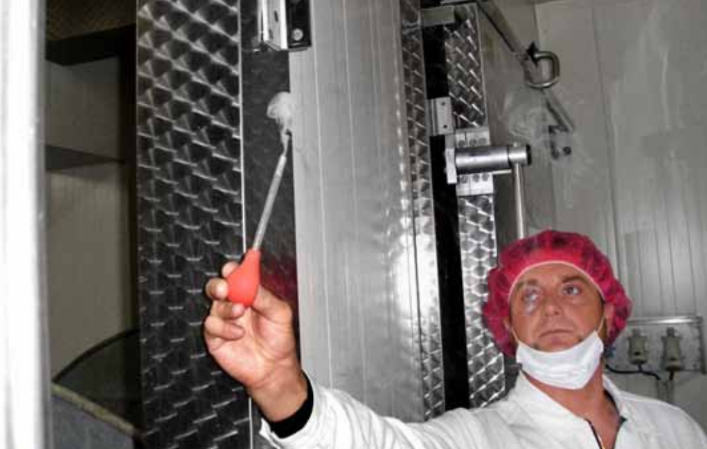
Die richtige Erfassung der Luftströmungen ist eine Grundvoraussetzung des Luft- und Hygienemanagements
