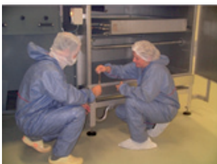
Messung der Oberflächenkeimbelastung innerhalb von Klimaanlage und Lüftungsaggregaten im Reifebereich
