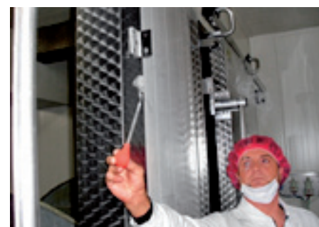
Visualisierung der Luftströmungen zwischen unterschiedlichen Hygienebereichen
