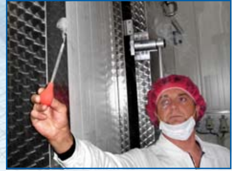
Überprüfung der Luftströmungsverhältnisse
