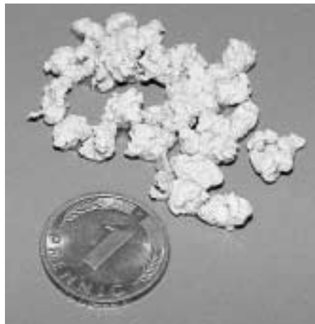
2: Bei den Rohstoffkomponenten zur Herstellung des Füllstoffes handelt es sich vor allem um Produkte aus dem „gelben Sack“. Ein spezielles Hochdruckextrusionsverfahren ermöglicht die homogene Verbindung der unterschiedlichen Füllstoffkomponenten
